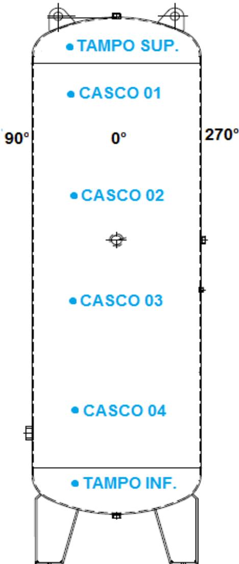
● **PONTOS DE MEDIÇÃO DE ESPESSURA**
