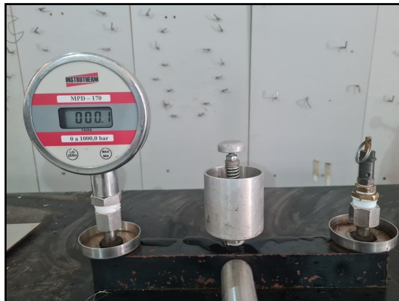
8.3 - INSTRUMENTO DURANTE A CALIBRAÇÃO
