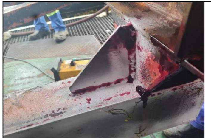
ACIONAMENTO EXTERNO REFORÇO VIGA 01 - REVELADOR
