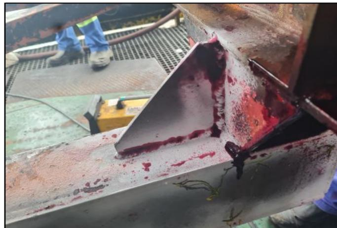
ACIONAMENTO EXTERNO REFORÇO VIGA 03 - REVELADOR
