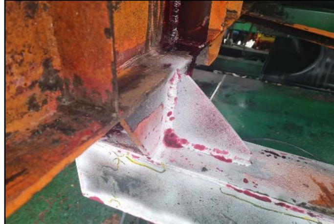
ACIONAMENTO EXTERNO REFORÇO VIGA 02 - REVELADOR
