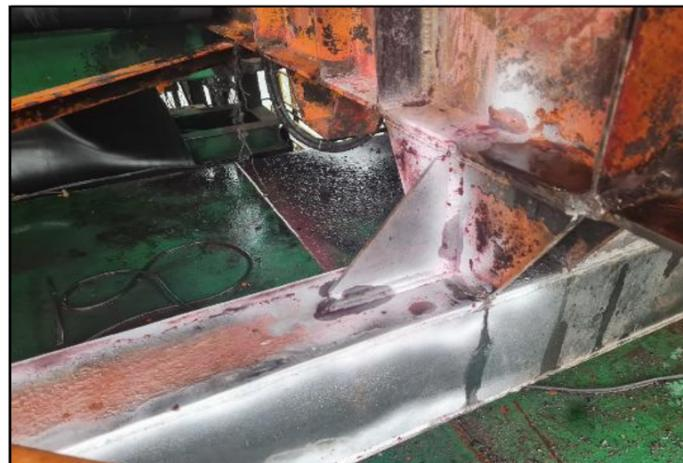
ACIONAMENTO EXTERNO REFORÇO VIGA 03 - REVELADOR
