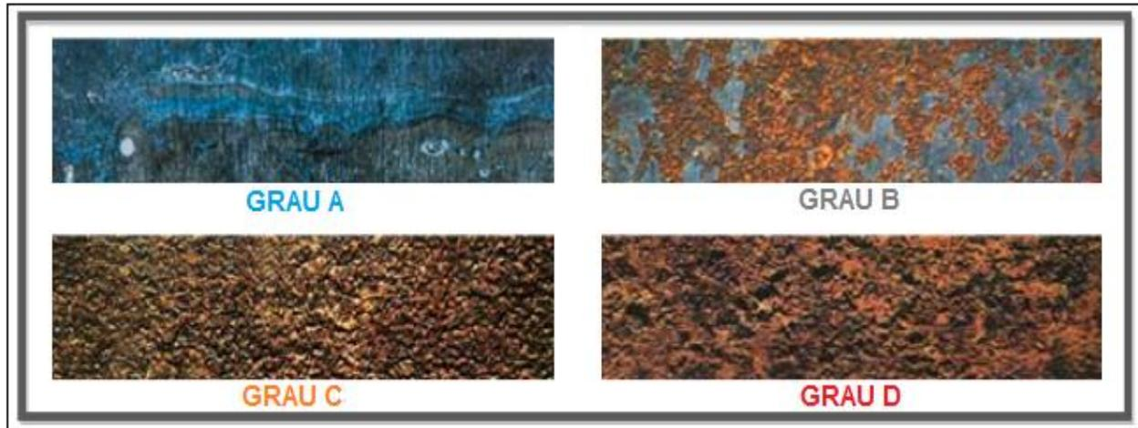
**Grau A** – Superfície de aço com a carepa de laminação praticamente intacta em toda a superfície e sem corrosão. Representa a superfície de aço recentemente laminada, **(limpeza periódica)**.
