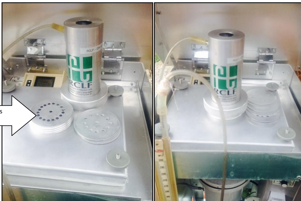
Placas perfuradas para calibração do HI-VOL Copo Calibrador sobre as placas
