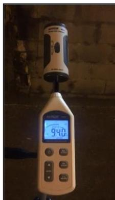
O Decibelímetro utilizado foi calibrado conforme Norma Técnica pelo **Calibrador AKROM KR94, Classe Tipo 2**.
