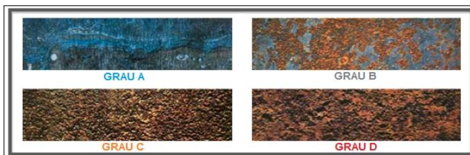
o **Grau A** – Superfície de aço com a carepa de laminação praticamente intacta em toda a superfície e sem corrosão. Representa a superfície de aço recentemente laminada, (limpeza periódica).
