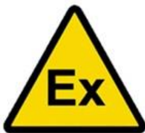
Figura 6.2.3.a - Placa de sinalização para áreas classificadas.
